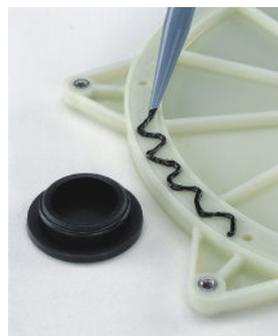
7. Dichtklebemasse in Wellenlinien zwischen den beiden Rillen auftragen und mit Spachtel o. ä. verteilen.
