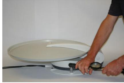
9. Dreheinheit mit einem Drehmoment-Schlüssel wieder auf die Montageplatte schrauben.
