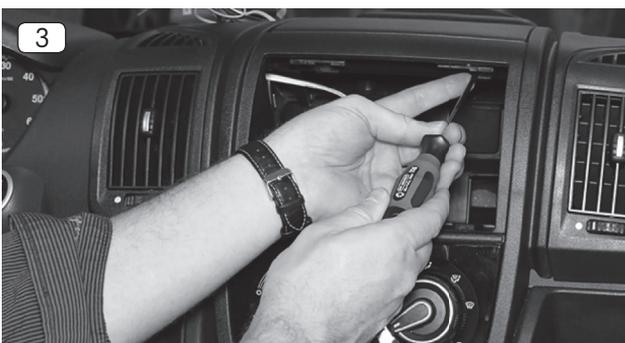
3. Entfernen Sie die beiden oberen originalen Torxschrauben (T25).
