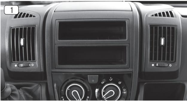
1. Entfernen Sie die beiden Ablagefächer gemäss Herstellerangaben.
