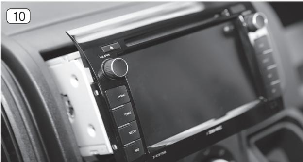
10. Verbinden Sie alle zuvor in den Radioschacht verlegte Kabel und das originale Antennenkabel mit dem ZENEC-System (Nr. 1). Verwenden Sie bei Bedarf den im Lieferumfang enthaltenen ISO-DIN Antennenadapter (Nr. 8).
